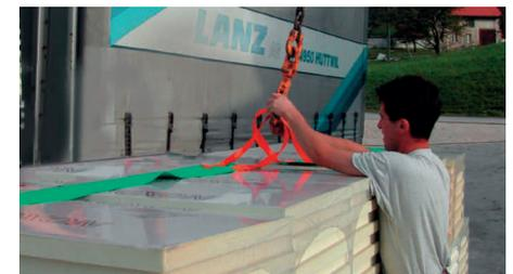
Extra breiter Gurt für kantenschonendes Heben von Isolationsmaterial und Styroporplatten.
