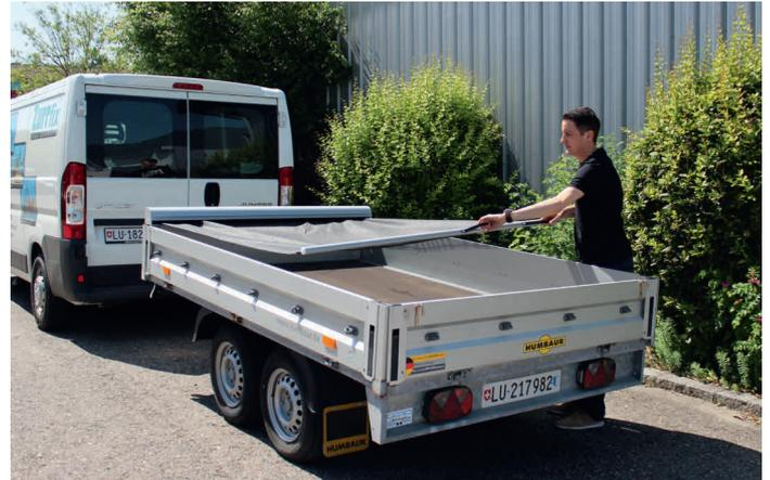
Die Auszug Abdeckung ist platzsparend und vor Witterung geschützt im Einzugsgehäuse verstaubar. Besticht durch einfachste Handhabung. Schnell montiert durch Einhaken am Ende des Anhängers, zusätzlich mit 4 Gummibändern fixiert.
