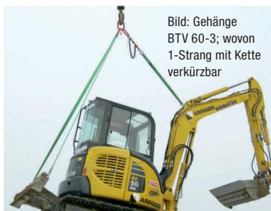
Bild: Gehänge BTV 60-3; wovon 1-Strang mit Kette verkürzbar
