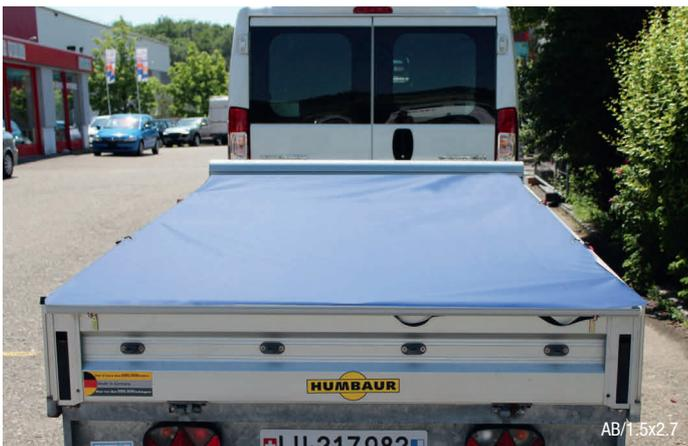
Automatic - Auszugabdeckplane (AB) aus wasserdichter Plane 650g/m<sup>2</sup>, blau, maximale Auszugslänge 2.7 m, maximale Breite 3.0 m, pro Seite je 2 Ösen, mit Endprofil und zwei Handschlaufen.
