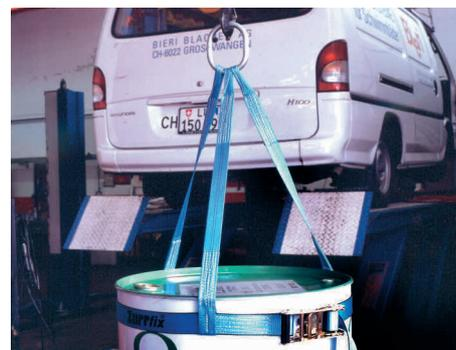
Für den senkrechten Transport von Fässern. Die Ratsche erlaubt stufenloses Einstellen auf alle Fassgrößen bis max. 60 cm Durchmesser.
