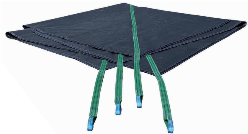
Die Hebe- und Schuttblache, 5 x 5 Meter schwarz aus witterungsbeständigem Polypropylen für höchste Ansprüche, ist am Rand umgelegt und mit Sicherheitsgurtband verstärkt. Im Kreuz sind zwei Hebegurte aufgenäht mit je einem zusätzlichen Meter Hebeband als Verstärkung auf der Innenseite.
