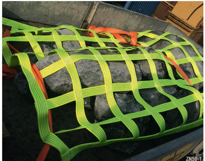
Sicherungsnetz mit YL Band, LC 2500/5000 daN. Im Garten- und Landschaftsbau müssen die verschiedensten Güter, wie Pflanzen, Baumaterialien, Baumaschinen und Werkzeuge zu den Einsatzorten gebracht werden. Ladungssicherungsnetze sind flexibel einsetzbar; besonders geeignet für Findlinge, Quadersteine usw.
