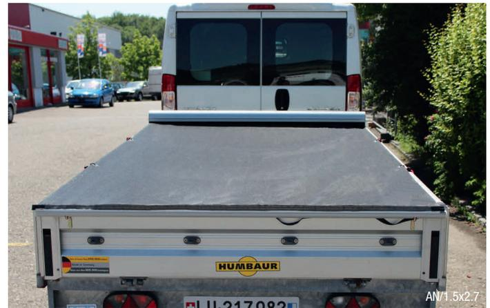
Automatic - Auszugsabdecknetz (AN) aus luftdurchlässigem Netz 400g/m<sup>2</sup>, schwarz, maximale Auszugslänge 2.7 m, maximale Breite 3.0 m, pro Seite je 2 Ösen, mit Endprofil und zwei Handschlaufen.
