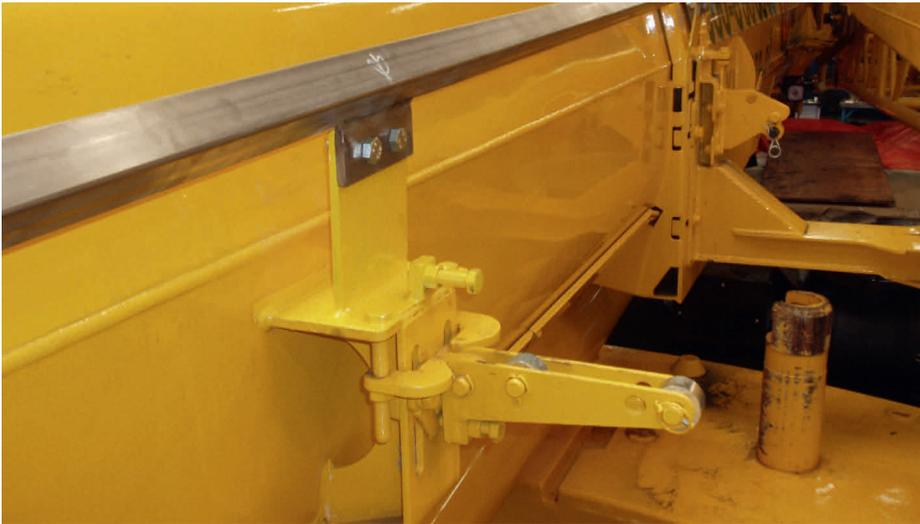
Verwenden Sie vorhandene Strukturelemente um das Tramsystem zu montieren, dies ist die schnellste und die einfachste Installationsart. Untersuchung der Struktur durch einen Techniker ist erforderlich, wenn die Struktur nicht geeignet ist, sind zusätzliche Halter als Verstärkungselemente oder neue Schweiß Verankerungen erforderlich.
