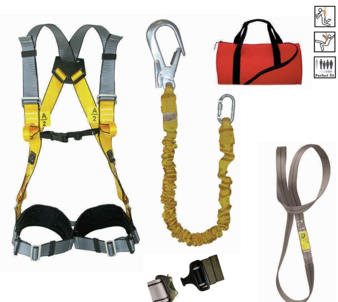
Universal Auffanggurte vollverstellbar mit Rücken D-Ring und vorderen Brustaufhängösen und Automatikschnellverschlüssen nach EN 361. Mit zwei Werkzeughalterungen. Farbe gelb/grau mit Beinpolsterung. Verbindungsmittel mit integriertem Bandfalldämpfer und Twistlockkarabiner und Gerüsthaken. Mit Bandschlinge 2 Meter verpackt in der robusten Zurrfix-Tasche.
